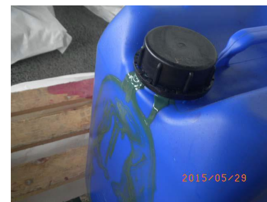
キャップにわずかな緩みがあり、気圧差の影響もあり漏えいが発生したと思われる。
