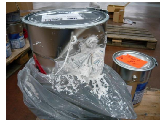
容器がへこんでいることから、航空会社での取り扱い中(もしくは輸送中)に漏えいが発生したと推測される。
